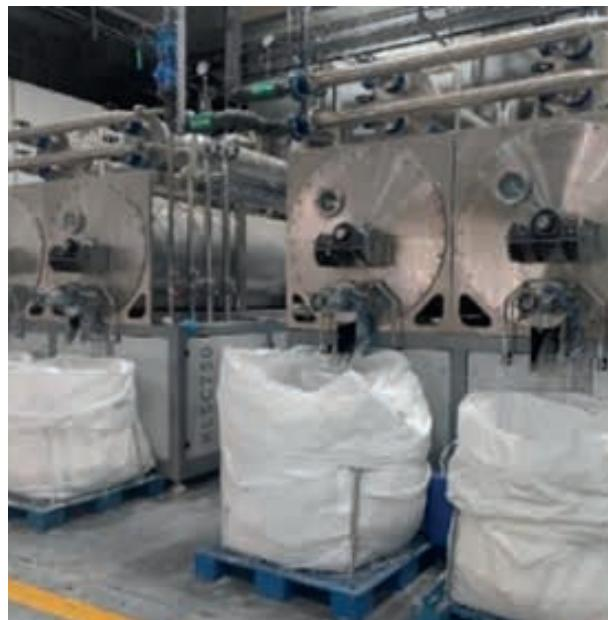
剩餘污泥於鑄造生產廠區的廢水處理過程中產生。為減少污泥處置量，沭陽廠區使用污泥乾燥機，透過蒸發去除污泥的含水量。年內，七台減壓乾燥機及機械蒸汽壓縮設施於昆山廠區獲落實採用。隨著該等設施滿負荷運行，預計將減少在我們生產工廠中處置的污泥數量約40至60%。
